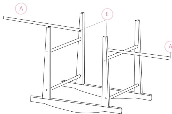
Paso 3. Unir dos extremos de la pieza A, a C mediante dos tornillos E.
