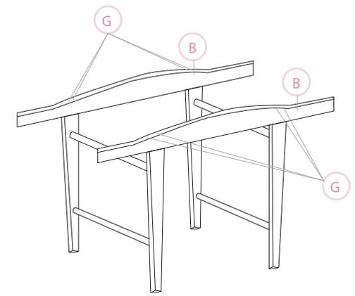
Paso 2. Unir pieza B y C, mediante 8 tornillos G (dos en el interior de las cuatro piezas C).
