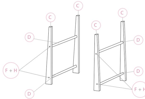
Paso 1. Unir pieza C y D, mediante tornillo F con embellecedor (H).
