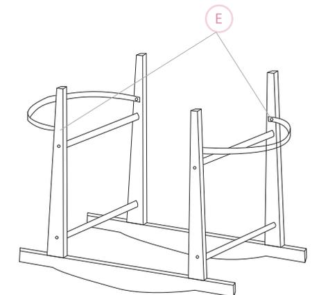
Paso 4. Unir el otro extremo de la pieza A, a C mediante dos tornillos E.
